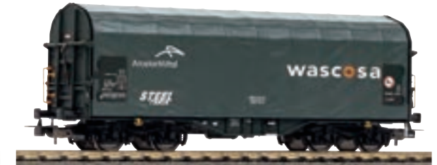
24640 Schiebeplanwagen Shimmns Wascosa Ep. VI, mit geschlossener Plane
